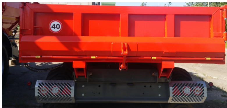
Hydrauliskt nedfällbar bakstam. Avtagbar topphängd bakstam
